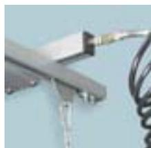
*Branchement direct des outils pneumatiques: Ils peuvent être branchés directement à l'accouplement d'air comprimé fixé sur la potence.*
