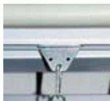
*La glissière, fixée directement à la potence, est réglable en profondeur. Un trolley pour supporter les outils peut y être suspendu.*
