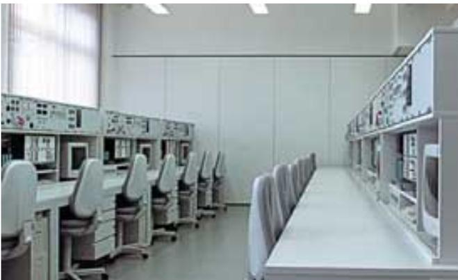
Tables escamotables avec des superstructures combinées. Dans la partie inférieure à gauche se trouvent des modules et platines actives, au-dessus un emplacement pour un automate programmable, et à droite un rangement pour le clavier et un coffre pour le moniteur. L'ensemble est entièrement escamotable. Au-dessus il y a une superstructure pour appareils 19"/6HE qui se trouve remontée pour la formation des électromécaniciens.
