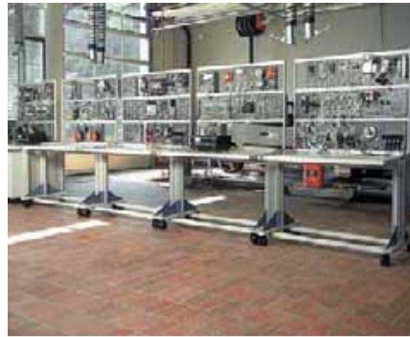
Les modèles Didactic nécessitent suffisamment de place. Des cadres d'essai DIN A4 sur 3 rangées garantissent des expérimentations professionnelles. Les postes mobiles sont en plus connectables entre eux pour former un ensemble rigide et stable.
