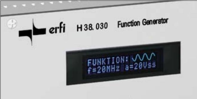
Le nouveau affichage graphique de la technologie à vide à fluorescence permet une lecture excellente même à une distance de 3 m, indépendamment de l'angle de lecture. L'affichage est en bleu et d'une haute netteté et brillance.
